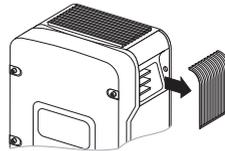
5. Beide Schrauben rechts und links am Wechselrichter lösen, die ihn mit der Wandhalterung verbinden.
